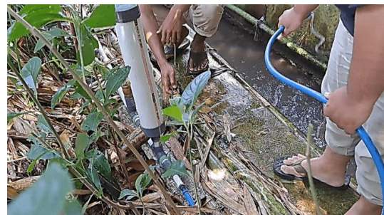
Gambar 6. Pengecekan output pompa hidram
