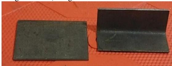
Gambar 2. Hasil Pengujian Plat Ketebalan 3 mm
