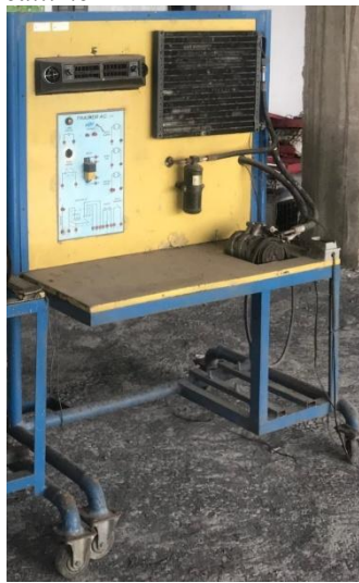
Gambar 2. Alat Peraga Sistem AC Mobil Kondisi Sebelum Diperbaiki dan Dimodifikasi
