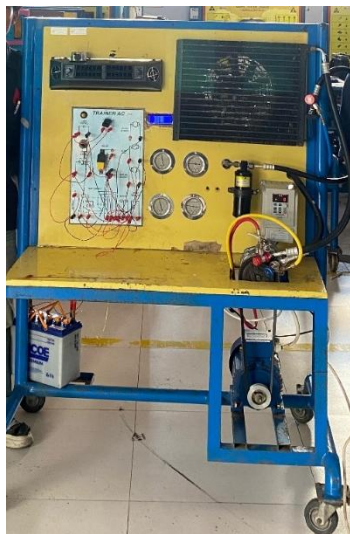
Gambar 3. Alat Peraga Sistem AC Mobil Kondisi Sesudah Diperbaiki dan Dimodifikasi
